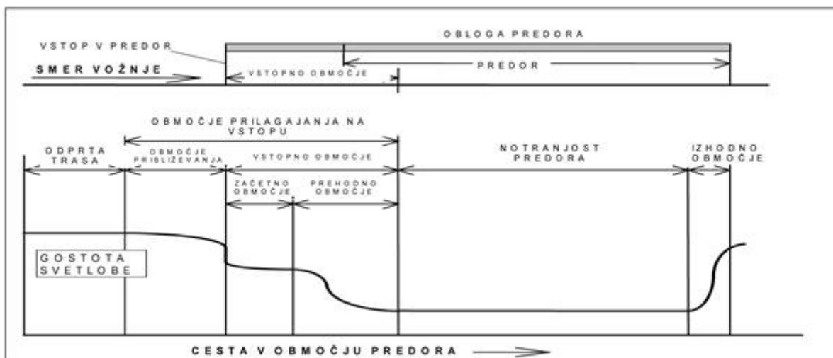
Slika XIV-1: Shematični prikaz poteka gostote svetlobe pri vožnji skozi predor – podnevi
