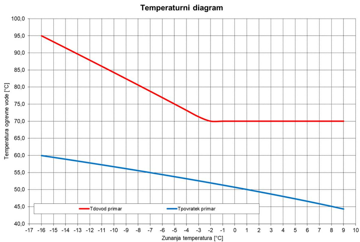
T dovod = temperatura dovoda ogrevne vode, ki jo zagotavlja distributer toplote na odjemnem mestu
